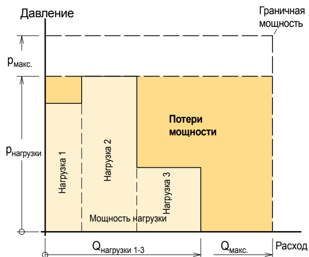
Диаграмма 1. Система с постоянным расходом с нерегулируемым насосом.
